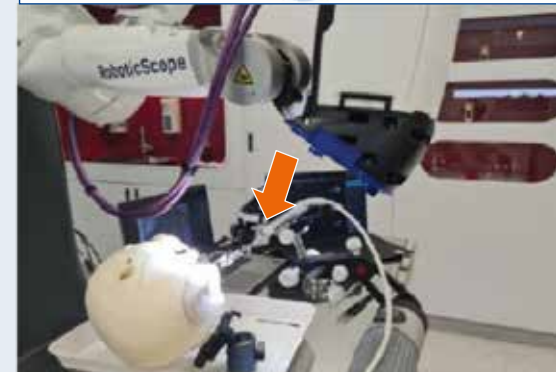
Testsetting Otoarm-Otodrive® mit Robotic Scope®
